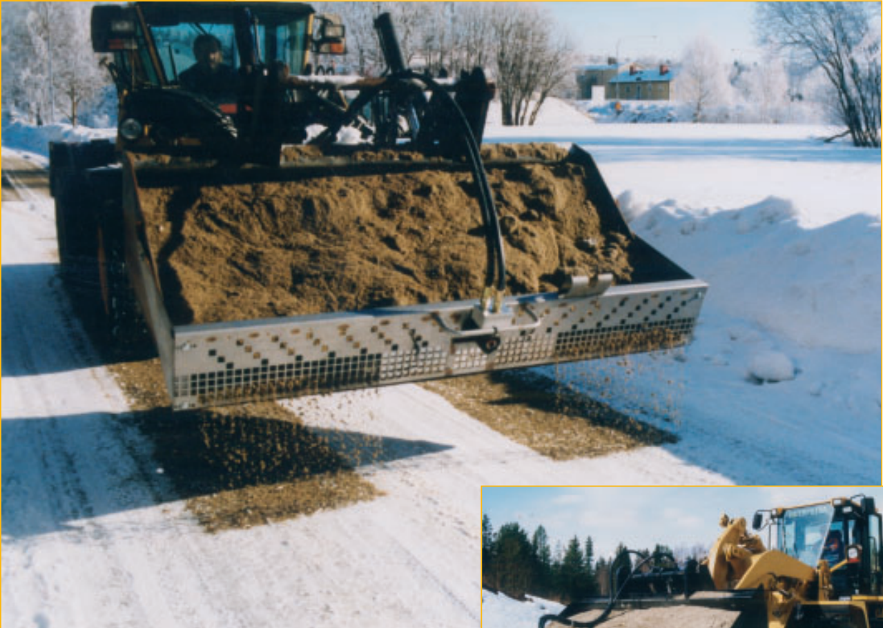
SPÅRSANDNING. Enkelt med lösa aluminiumplåtar.
