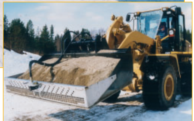
SPÅRSANDNING. Enkelt med lösa aluminiumplåtar.
